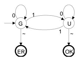
Der Automat besitzt die vier Zustände G (gerade Anzahl an Einsen), U (ungerade Anzahl an Einsen), ER (error, Fehler erkannt) und OK (keinen Fehler erkannt). Der Zustand G ist der Anfangszustand, die Zustände OK und ER sind Endzustände. Die Folge von Bit ist mit dem Zeichen ~ abgeschlossen.
